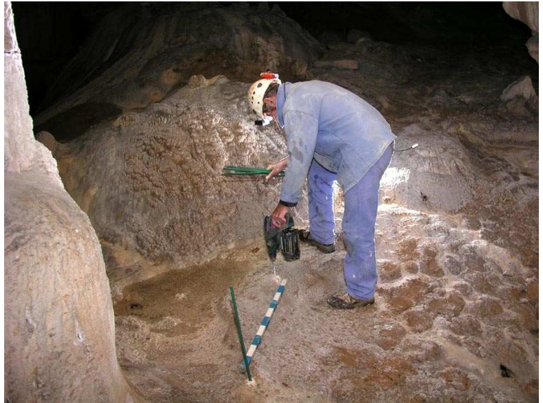
Fig. 1 : Pose des piquets au perforateur.
