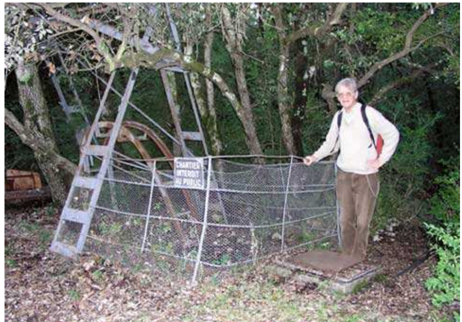
Figure 7 : Chèvre métallique de l'aven Flahaut (Marzal 2).
