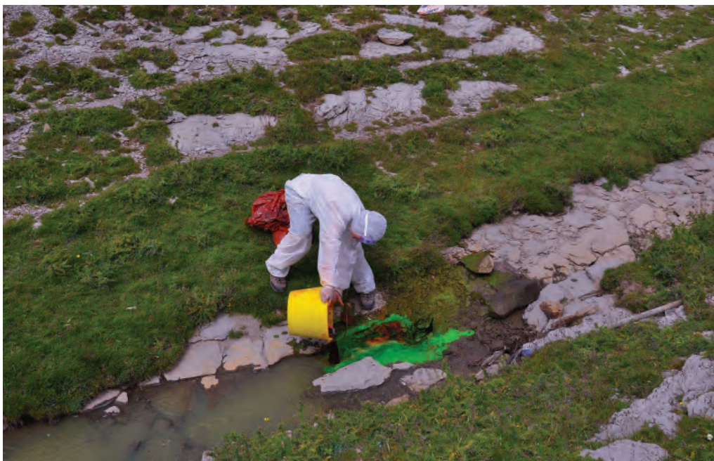
✓ ✓ Fig. 4: Le 16 novembre 2013, le Coulomp restitue la fluorescéine que nous avons injecté à Lignin six jours avant et arrive tout vert au hameau d'Aurent...
